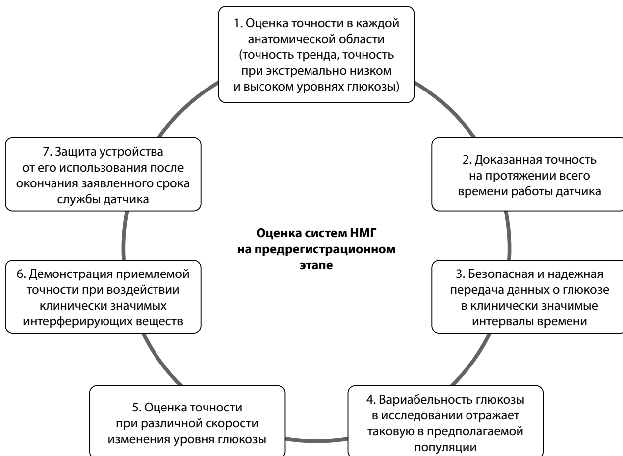
Рисунок 1. Минимальные требования к точности систем непрерывного мониторинга глюкозы, предложенные Европейской экспертной рабочей группой [13].
