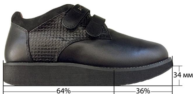
Рис. 1. Внешний вид испытуемой обуви. Нанесенная разметка указывает на расположение линии переката относительно пятки, которая составляет 64% длины подошвы, и на расстояние подошва-пол под пальцами.
