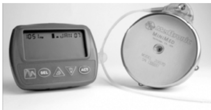
Рис. 1. Имплантируемая инсулиновая помпа для ВВ-инфузии инсулина и пульт управления.
