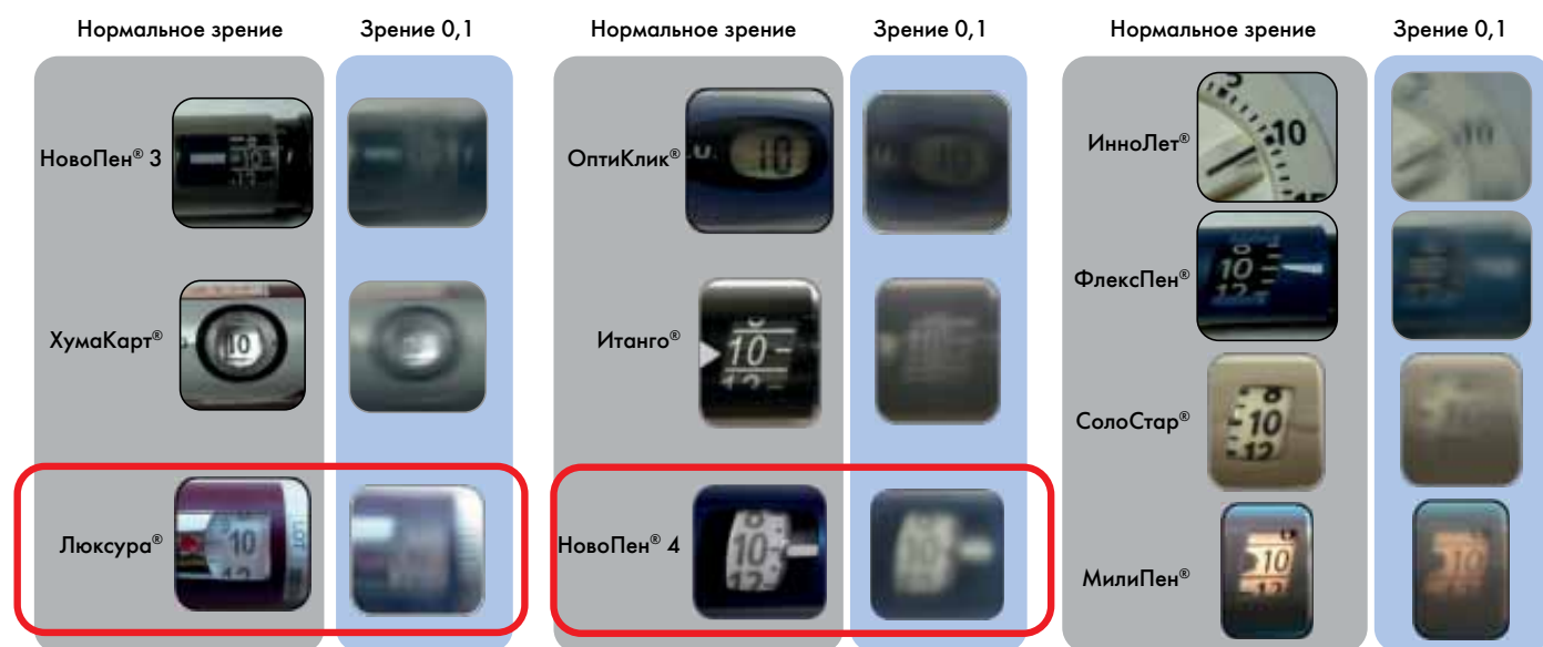
Рис. 3. Читаемость цифр на дисплее индикатора дозы различных инъекторов пациентами с нормальным и сниженным зрением
