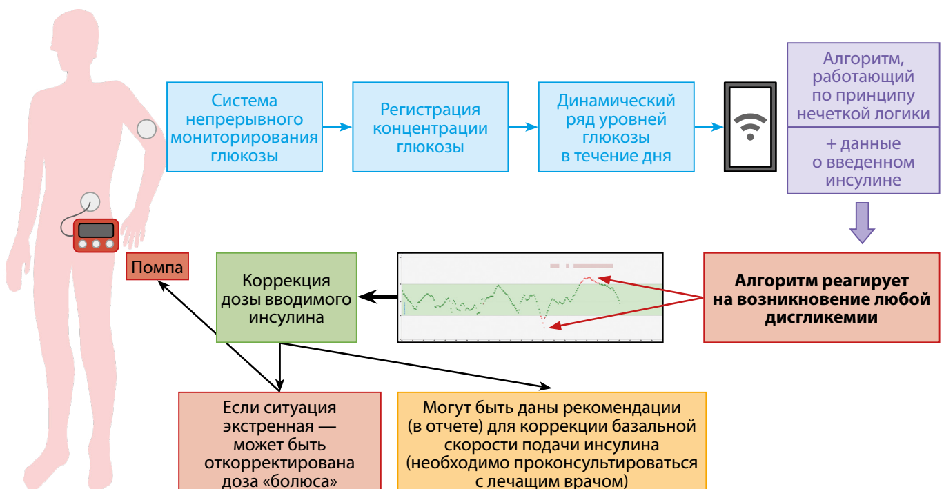
Рисунок 2. Принцип терапии методом закрытой петли, использующей алгоритмы с системами передачи данных в облачное хранилище DIY-CLS.
